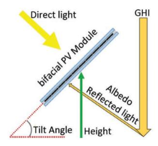
Fig. 6: Bifacial solar module
